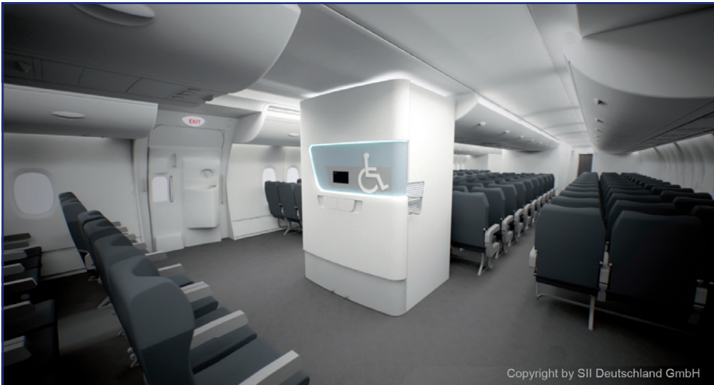
Bild 4: Barrierefreie Bordtoilette für den Cross-Aisle Bereich: Eine Verschärfung der Lufttransportregulierungen könnten Fluggesellschaften schon bald dazu führen, weite Teile ihrer Flotte mit dieser Technologie auszurüsten
