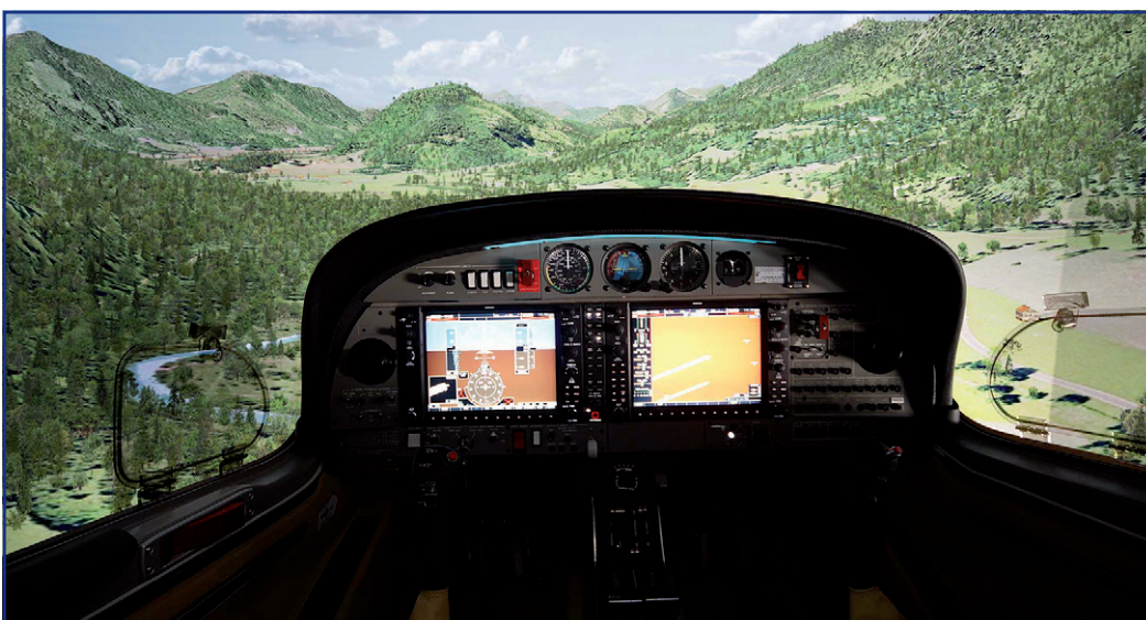
Bild 5: Roboter-gestützter Flugsimulator – Hiermit üben Piloten in Bodennähe reale Manöver, die sonst nur in der Luft möglich sind.
