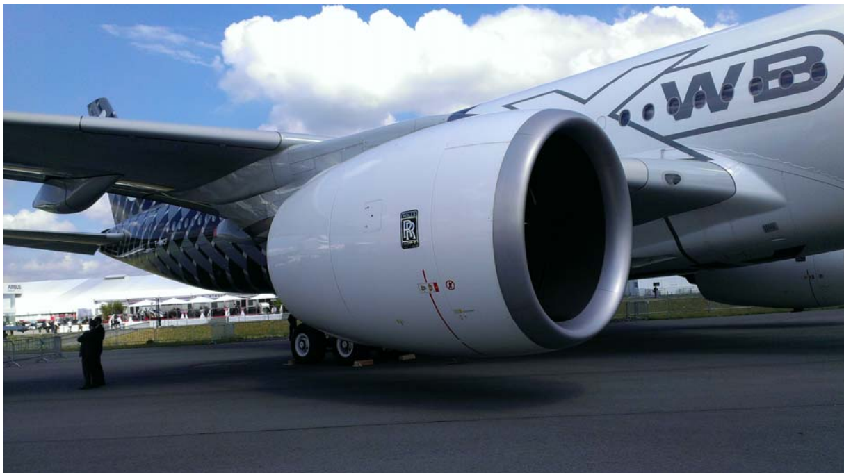
Hier versteckt sich eines des zwei Rolls-Royce Trent XWB Triebwerke im Airbus A350
