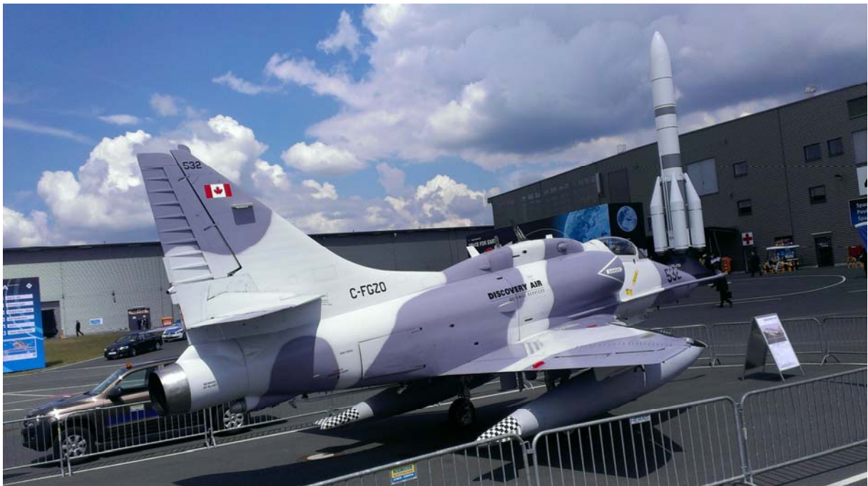
Hier eine McDonnell Douglas A-4 Skyhawk des kanadischen Unternehmens Discovery Air Defense. Von diesem Typ wurden auch der Bundeswehr ab 2015 sieben Jets für Trainingsmissionen zur Verfügung gestellt. Das Strahlentriebwerk ist bei diesem Modell ein Pratt & Whitney J52 P408 mit 5.080 kp, welches den Skyhawk mit knapp unter 1.100 km/h durch die Lüfte schiebt, so ist auf der nebenstehenden Tafel zu lesen.
