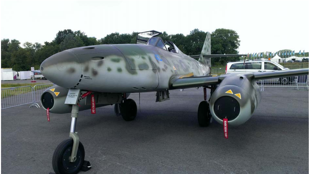
Die Messerschmitt Me 262, gebaut und eingesetzt im 2. Weltkrieg, der erste 2-strahlige Düsenjet der Welt mit ihren BMW-Strahlentriebwerken.
