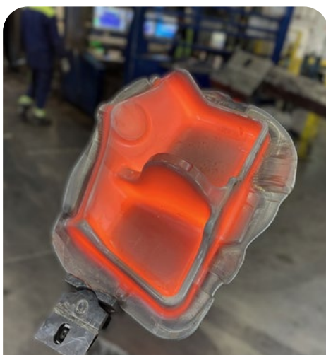
← Titanschmiedeteil für den Airbus A350, Otto Fuchs
