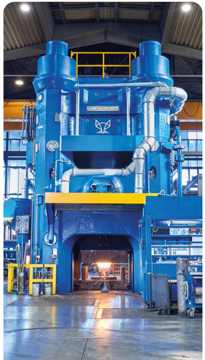
→ Hydraulische Schmiedepresse (Presskraft 30.000t) zur Herstellung großer Titan- und Aluminium Strukturteile und zur Herstellung geschmiedeter Triebwerksscheiben auf Basis Titan- und Superlegierungen, Otto Fuchs
