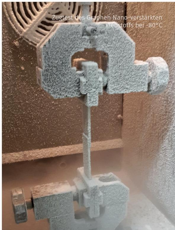
Zugtest des Graphen Nano-verstärkten Klebstoffs bei -80°C
