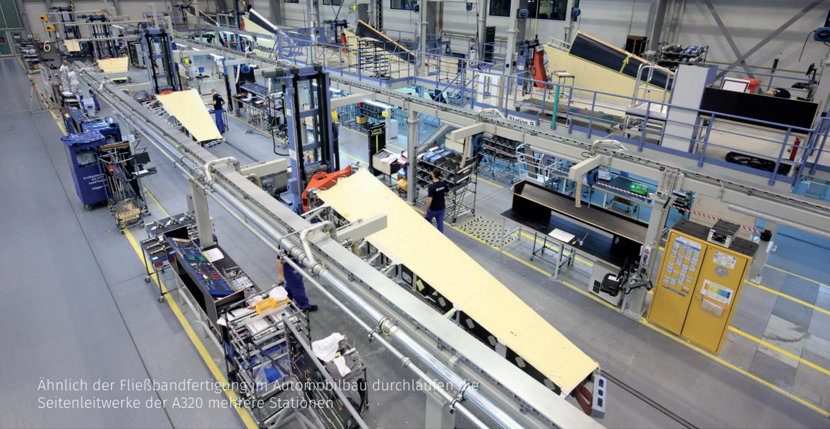
Ähnlich der Fließbandfertigung im Automobilbau durchlaufen die Seitenleitwerke der A320 mehrere Stationen
