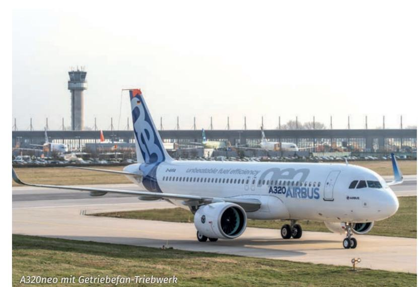
A320neo mit Getriebefan-Triebwerk
