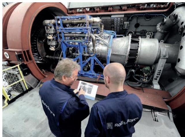
Im Rahmen des E3E-Programms entwickeltes Kerntriebwerk auf Höhenprüfstand in Stuttgart
