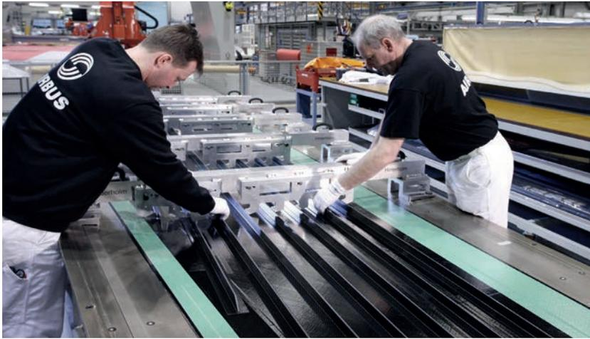
CFK-Produktion bei Airbus
