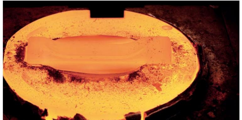
Titanaluminidschaufel nach dem Schmelzen im Isothermgesenk
