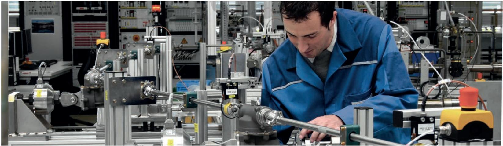
Liebherr Fly-by-Wire Prüfstand
