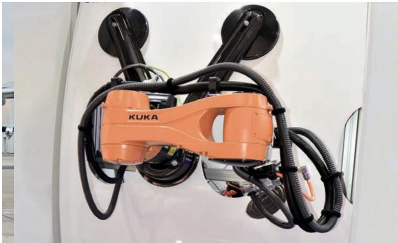
Mobiler Roboter zur Flugzeugreparatur
