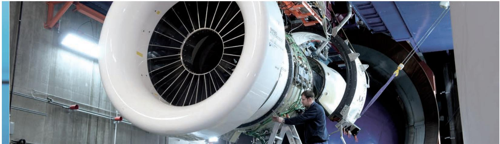
PurePower® PW1500G Triebwerk mit Getriebefan auf dem MTU-Prüfstand München
